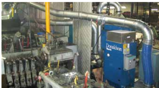
WSO (humo) Moldeado en frío 1,200 cfm
