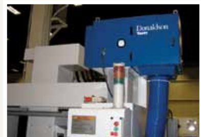
DRYFLO MMA Maquinado en agua 390 cfm
