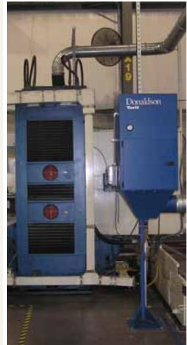
WSO (Neblina de Agua) Molino Horizontal 850 cfm
