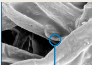
Medios de Celulosa 10 Micrones (600x)
